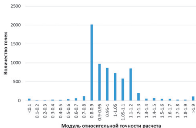
Рис. 7. Гистограмма распределения точности расчета по модели Unified с предложенным авторами механизмом
