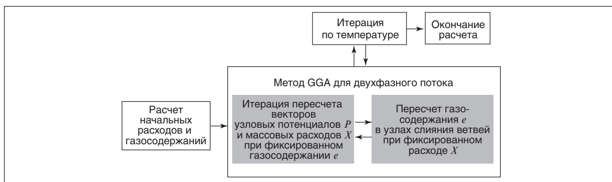
Рис. 2. Декомпозиция задачи при расчете потокораспределения неизотермического «замороженного» двухфазного течения
