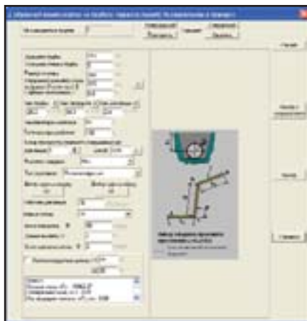
▲ Рис. 3. Расчет Z-образного компенсатора с непараллельными плечами
