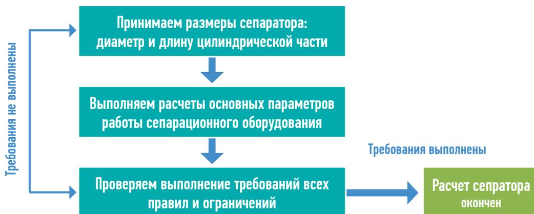
Рисунок 1 – Алгоритм расчета сепаратора
