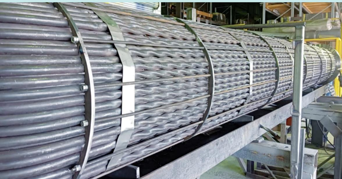
Рисунок 1 – Трубный пучок с витыми трубками производства ООО «СТИМ»
